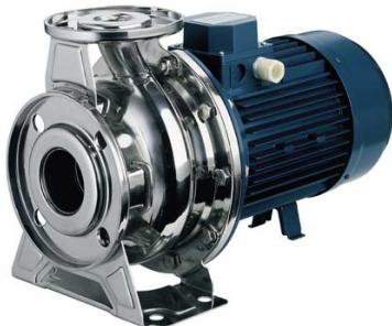
Queste pompe con tutte le parti in contatto con il liquido realizzate in acciaio inox e progettate secondo direttive DIN 24255 (UNI EN 733), sono usate per pompare liquidi chimicamente puliti senza parti solide in sospensione in impianti di riscaldamento / condizionamento, sistemi di irrigazione, unità anti incendio etc. La vasta gamma disponibile e la loro affidabilità rendono la pompa utilizzabile in ambiti agricoli, civili ed industriali.
