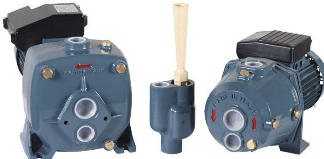
Elettropompe a una girante (JAP 80-100 M-T) o a due giranti (JAP 150-200-300 M-T) con bocca di aspirazione assiale e bocca di mandata radiale rivolta verso l'alto. La particolarità di questo modello è l'elevata profondità di aspirazione raggiungibile tramite un'opportuna installazione del corpo eiettore. Indicate quindi in tutti quei casi ove vi sia il bisogno di aspirare a profondità comprese dai 10 mt ai 50 mt.
