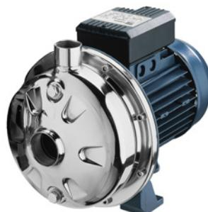
Pompe monogiranti realizzate completamente in acciaio inox particolarmente indicate per usi domestici, agricoli ed industriali. Tutte le parti in contatto con il liquido pompato sono in acciaio inox Aisi 304 per garantire massima igiene e resistenza alla corrosione.
