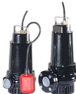
Pompe con girante bicanale aperta particolarmente indicate per usi artigianali ed industriali, per il pompaggio dia que pulite o poco sporche o liquidi similari. Il forte filtro in ghisa alla base della pompa impedisce il passaggio alle parti solide che potrebbero danneggiare la pompa.
