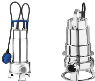
Pompe per drenaggio di acque pulite o fognature completamente realizzate in acciaio inox AISI 304 e con giranti monocanali o vortex, adatte ad usi domestici, agricoli e industriali. Tutti i componenti sono in acciaio inossidabile per garantire massima resistenza contro la corrosione. Sono disponibili con o senza galleggiante. Le pompe SX sono disponibili sia con mandata filettata che con mandata flangiata DN50 (eccetto SX/80 e 100).
