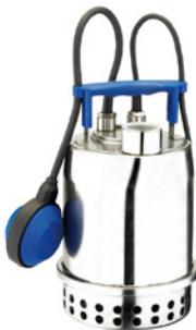
Elettropompe sommergibili per acqua pulita / fognature leggere completamente realizzate in acciaio inox AISI 304 adatte soprattutto per applicazioni domestiche (drenaggio di scabinati, garage, cantine o luoghi soggetti a inondazioni, fontane da giardino, svuotamento di vasche e serbatoi). Disponibili con o senza galleggiante (normale o magnetico). Le DOX/40 hanno la girante in noryl. Le DOX/50 possono essere fornite anche con girante vortex.
