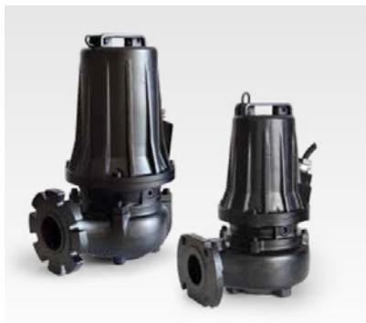
Queste elettropompe trovano largo impiego in impianti fognari di tipo civile ed industriale. Particolamente robuste ed affidabili, sono disponibili con giranti Vortex o Monocanal. Tutte le pompe sono dotate con doppia tenuta meccanica e camera d'olio interposta, sensore di umidità inserito nella camera d'olio, protezione termica. Per maggiori informazioni, prego consultare la nostra rete di vendita o il nostro sito [www.stac-ts.com](http://www.stac-ts.com).
